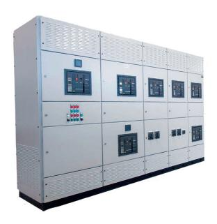
Низковольтное комплектное устройство «Аврора» (далее НКУ) предназначено для приема и распределения электрической энергии трехфазного переменного тока частотой 50Гц напряжением 0,4 кВ и 0,69 кВ в сетях с глухозаземленной или изолированной нейтралью, управления и защиты электрооборудования от перегрузок и токов короткого замыкания.
